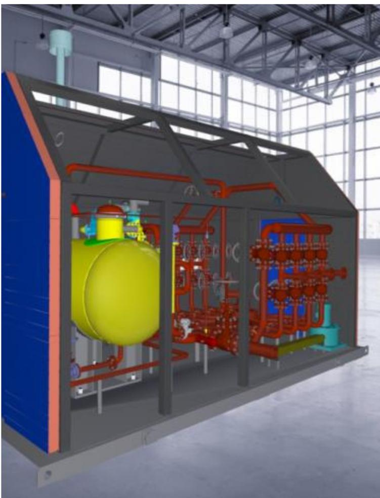
Установка УИДН-1 предназначена для непрерывных или дифференциальных измерений расходов и количества компонентов, полученных в результате сепарации продукции соответственно одной или нескольких нефтяных скважин, а также индикации, архивирования и передачи результатов измерений и аварийных сигналов на диспетчерский пункт нефтегазодобывающего предприятия.
